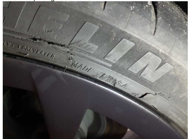
Beschädigung #3: Rad/Reifen: Reifen vorn rechts - beschädigt - erneuern
