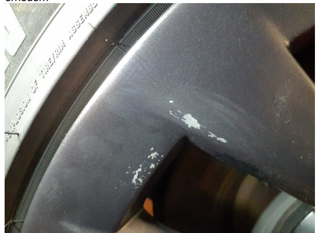
Beschädigung #4: Rad/Reifen: Leichtmetallfelge vorn links (Lackabplatzung) - Lackmangel - Wertminderung
