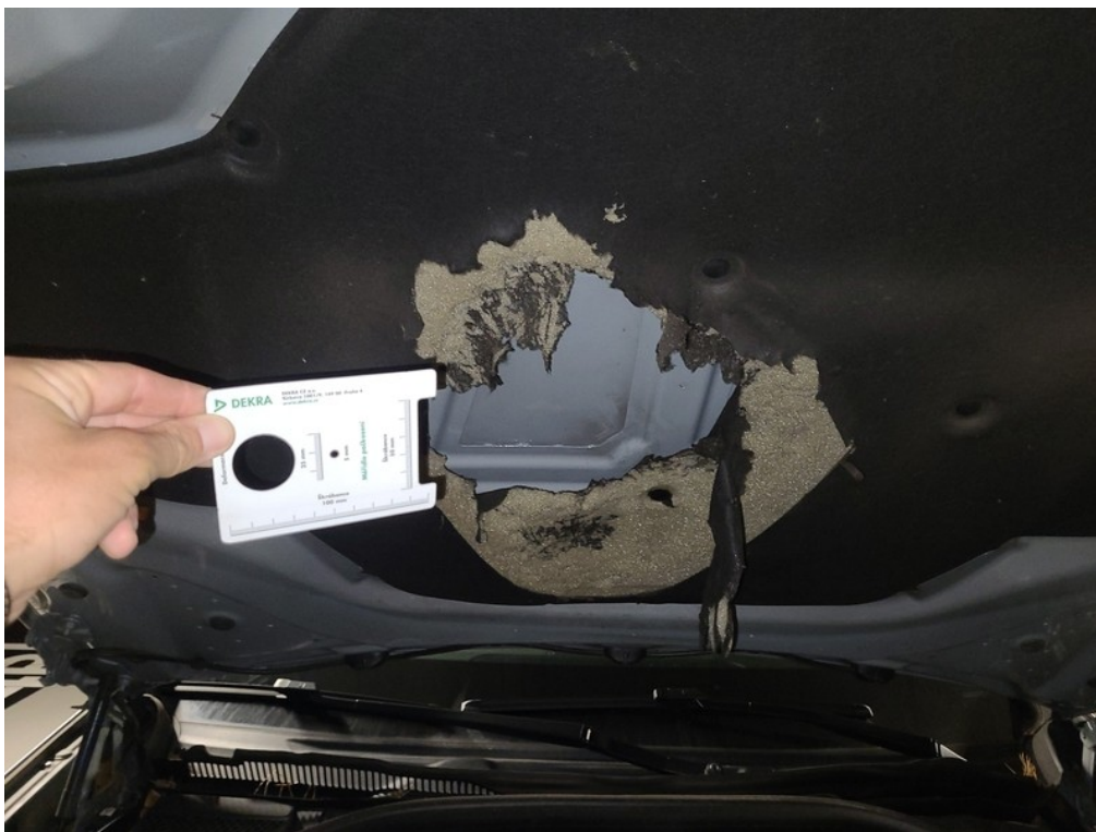
15 Hluková izolace víka motoru - Prasklina Umístění: Interiér (vnitřní prostor)
